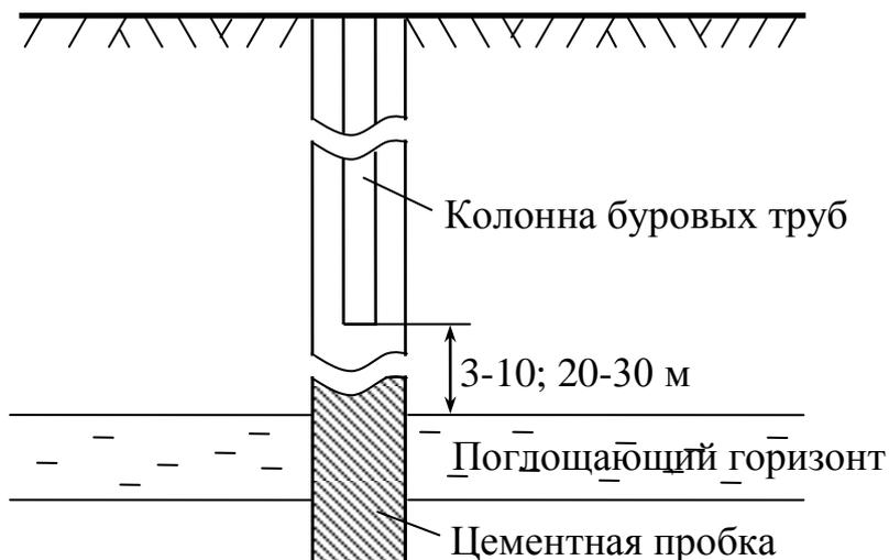
Рис.1 Схема тампонирующей колонны
